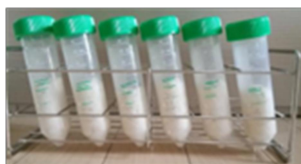
写真1 遠沈管による生地の体積の測定
