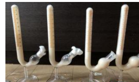
写真2 アインホルン管による炭酸ガスの測定
