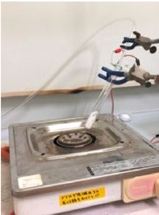
図3：カストナー法の実験装置図解
