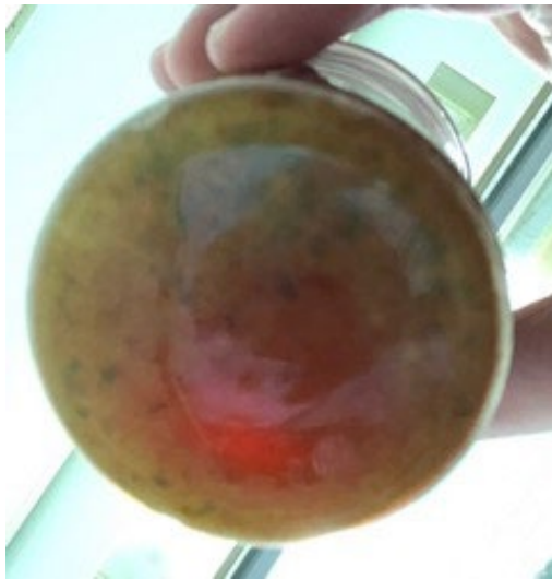
図6：通電後の電解装置の底に沈殿した黒色薄片
