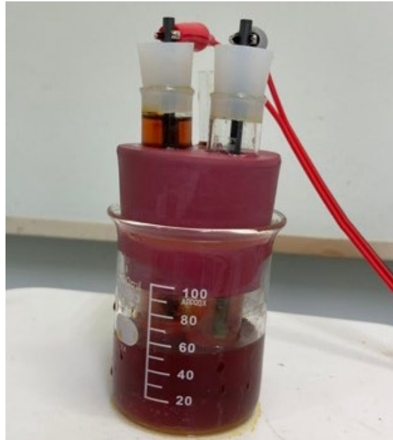
図4：通電後の電解装置の外観
