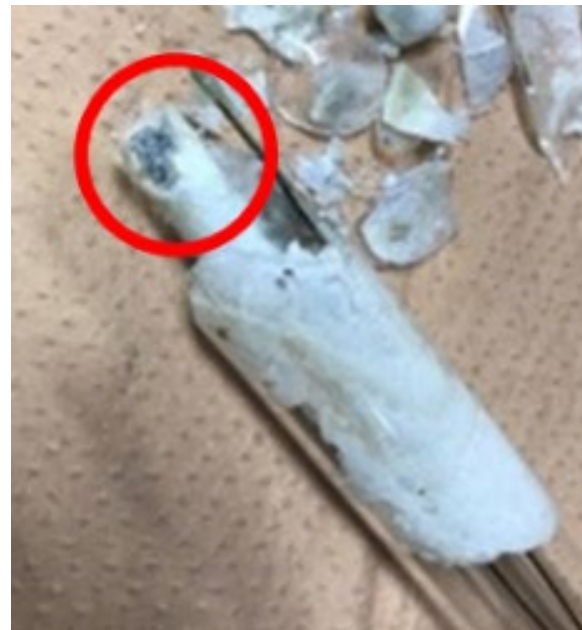
図8：通電後のパスツールピペットα内(陰極部)に見られた金属ナトリウム
